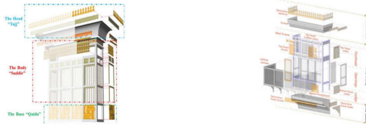
الشكل (3): الأجزاء الرئيسية للمشربية. المرجع: (Bagasi et al., 2021, pp. 4-5).
