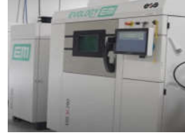
(شكل 3): يوضح جهاز (Metal 3D Printing) خاصة بالمجوهرات، (DMLS (Direct Metal Laser Sintering) طريقة تشغيل الجهاز https://www.youtube.com/watch?v=FxzFzbi0wF4
