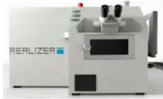
(شكل 4): يوضح جهاز (Metal 3D Printing) خاصة بالمجوهرات، (SLM (Selective Laser Melting) طريقة تشغيل الجهاز https://www.youtube.com/watch?v=jTUp810vOiQ
