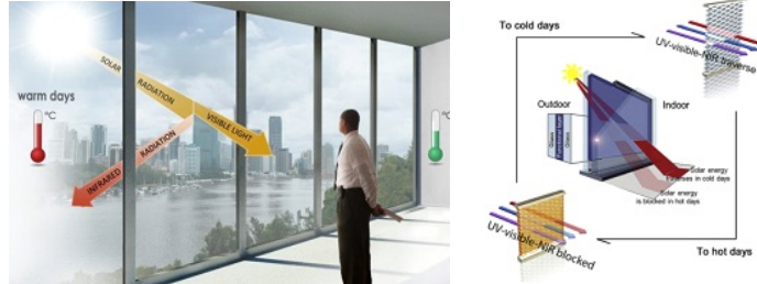
الشكل 14- توضيح لعمل الزجاج الكرومي ( https://www.uniteglass.com )
