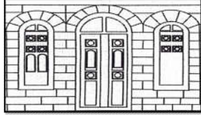
الشكل رقم (3): يبين مخطط بيت بني من الحجارة فيه باب رئيسي ذا قوس وكذلك النوافذ ذات الأقواس أيضاً.
